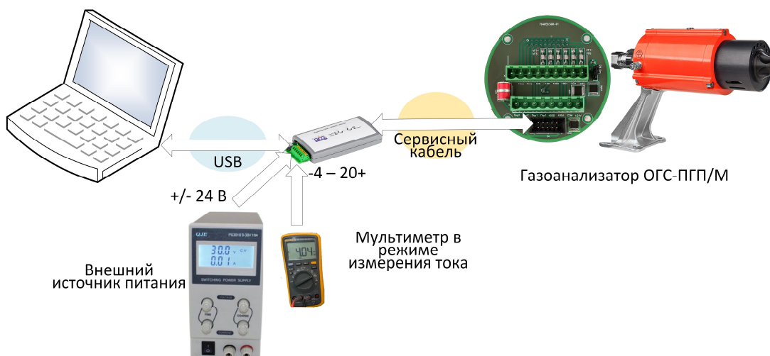
Рисунок А.2 – Вариант подключения конвертера к ОГС-ППП/М
